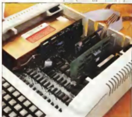
Fig. 2. Il nuovo sistema di controllo del Corvus. In alto: il Control Panel. Sotto: il Control del Corvus (slot 2) e il Control del software (slot 3).
